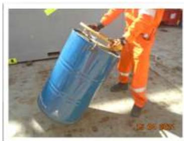
Acessório manual para movimentação de cilindros e garrafas.
